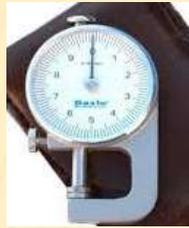
**MICRÓMETRO.** Herramienta imprescindible que nos permitirá medir las décimas de milímetro exactas del grosor de los papeles y cartones.
