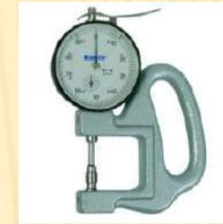
**MICRÓMETRO (Centésimas).** A través de sus dos esferas mediremos las décimas y las centésimas de milímetro. Muy utilizado para medir las escartivanas.
