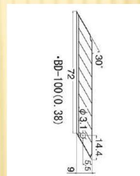
**Recambio estrecho cuchilla 30 °.** Cuchilla de acero carbono japonés estrecha de 9 mm.. Presentadas en blíster de 5 cuchillas (precio por blíster). Biseladas 30°, especial para trabajos de precisión.. Ref: 17375 **2,65 €**
