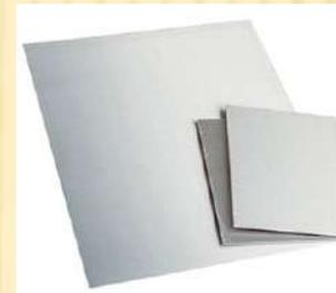
**PLANCHAS DE ZINC.** Plancha fina metálica usada para proteger el libro en los procesos de cortado de sobrantes (guardas, hojas,...) o usadas en caliente para enderezar las tapas.
