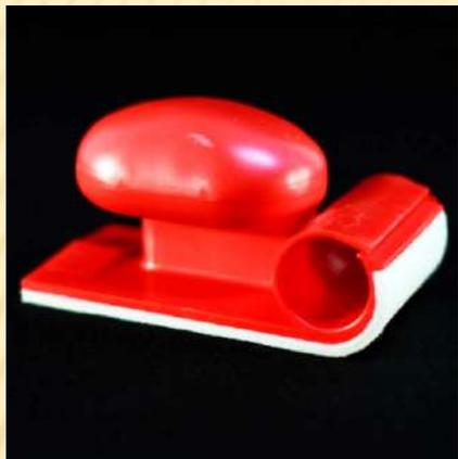
**PORTARROLLOS (ROJO).** Bloque de lijado muy práctico, dado que lleva su propio suministro de lija incorporado. Esquinas planas y contornos con el extremo redondeado. Para utilizar la lija se tira del rodillo de alimentación y se presione sobre el cojín acolchado. De esta manera se consigue una presión uniforme.
