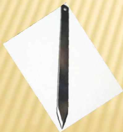
**REJÓN. 20 cm.** Se utiliza, principalmente, para cortar los hilos de los cuadernillos al descoser o limpiar los cuadernillos de cola. Ref: 1596
