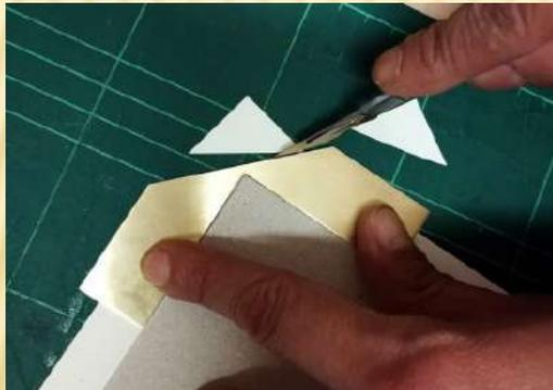
**ESCUADRA PARA CORTAR LAS ESQUINAS.** Metálica- Herramienta para cortar el sobrante de la tela y del papel de las esquinas. Conseguiremos esquinas iguales. Se apoya el ángulo en el cartón y se corta por el lado recto. Ref: 14542 **22 €**
